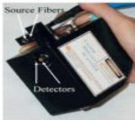
شکل ۲۲. پروب دستگاه اسپکتروسکوپی اپتیکی برای اندازه گیری غلظت فاکتورهای خونی پستان (۳)
